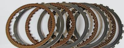
El cuerpo de válvulas de la transmisión está limpio y prácticamente libre de lodos después de 180.000 millas de servicio severo. Los discos de embrague sólo mostraron rastros de decoloración y obtuvieron una calificación de "bueno", la más alta posible, por deterioro/desgaste.
